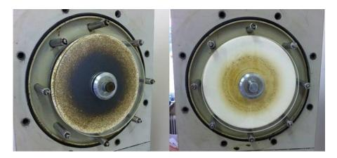
Abbildung 6: Membran nach kurzer Spülung mit Kaltwasser ohne Chemikalien (links) bzw. nach Spülung mit Heisswasser (rechts); Scheibenmembran 200 nm.
