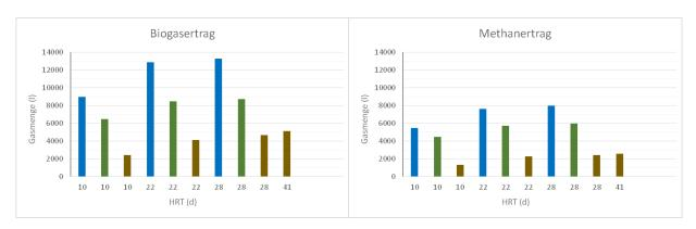
Abbildung 8: Verteilung des Biogas- und Methanertrags bei der Separierung von Rindergülle (blaue Säule = Rohgülle; grüne Säule = Dünngülle; braune Säule = Feststoff). Der Methangehalt für Rohgülle liegt bei 60 %, für Dünngülle bei 68 % und für die Feststoffe bei 55 %.
