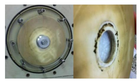
Abbildung 7: Beginnendes Membranfouling nach ca. 3.5 h Betriebszeit. Scheibenmembran mit 2000 nm Porengrösse. Die beiden Fotos wurden nach Reinigung der Membran aufgenommen. Die Schmutzpartikel unter der zentralen Achsschraube (Bild rechts) wurden bei der Reinigung nicht erfasst. Das Membranfouling ist im Innern der Membran sichtbar.
