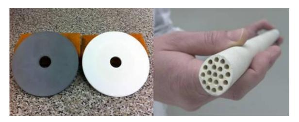
Abbildung 2: Die untersuchten Membranen. Links Membranscheibe SiC, in der Mitte Membranscheibe  $TiO_2/Al_2O_3$  und rechts die Rohrmembran  $ZrO_2-TiO_2/TiO_2-Al_2O_3$ .
