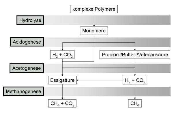
Abbildung 17: Schematischer Überblick über den anaeroben Abbauprozess mit den entsprechenden organischen Säuren der jeweiligen Abbaustufe [nach Hecht et al., 2007].
