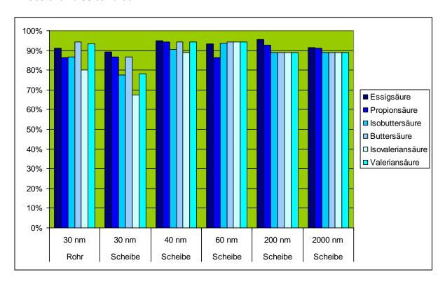
Abbildung 4: Säurerückhalt verschiedener Membranen mit Gärdünngülle aus einer landwirtschaftlichen Biogasanlage. Die Angaben sind mittels Massenbilanzierung berechnet.
