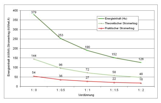
Abbildung 19: Energieinhalt (Hu), theoretischer Stromertrag und praktischer Stromertrag von Rinderrohgülle in Abhängigkeit der Verdünnung mit Wasser.
