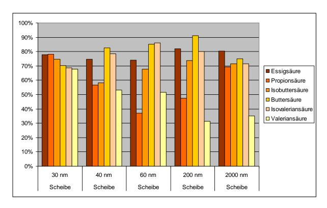
Abbildung 5: Säurerückhalt verschiedener Membranen mit Gärdünngülle aus einer landwirtschaftlichen Biogasanlage bei Aufkonzentrierung. Die Angaben sind mittels Massenbilanzierung berechnet.
