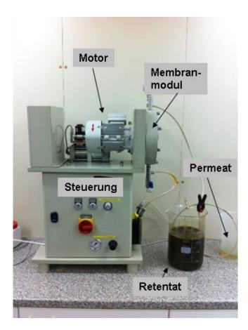
Abbildung 1: Die SSDF-Laboranlage mit der das Membranscreening erfolgt.
