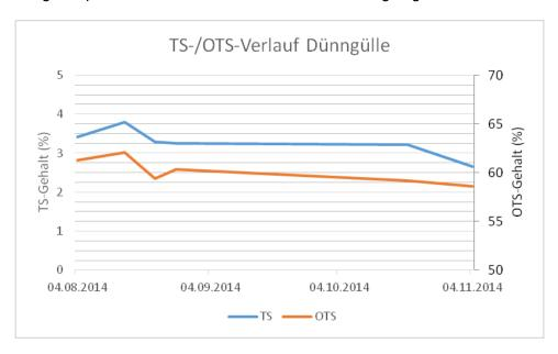
Abbildung 9: Verlauf der TS- und OTS-Gehalts in der Dünngülle während der Zwischenlagerung. Die Zeitdauer vom August bis November entspricht den Gärversuchen im MBRplus.
