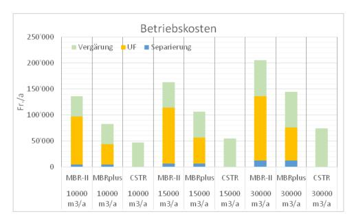
Abbildung 15: Vergleich der Betriebskosten für den MBR-II, den MBRplus und die konventionelle Vergärung im Rührkessel (CSTR)
