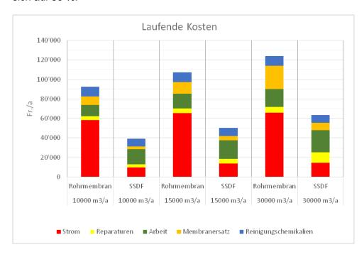
Abbildung 13: Laufende Kosten der SSDF (MBRplus) im Vergleich mit der Rohrmembran (MBR-II). In den Kosten sind die Aufwendungen für die Separierung und für die Vergärung nicht enthalten.
