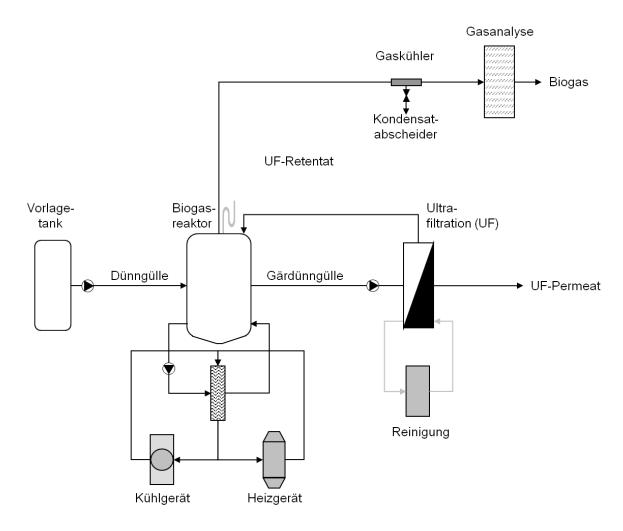
Abbildung 3: Skizze der halbtechnischen Versuchsanlage (MBRplus) mit der neuen UF (SSDF). Ein Teil des UF-Retentats wird als Überschussschlamm (ÜSS) aus dem System entnommen.
