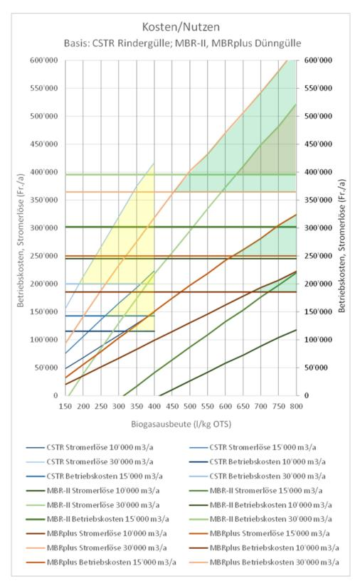
Abbildung 16: Kosten-Nutzen-Vergleich zwischen der konventionellen Rührkessel (CSTR), dem MBR-II mit organischen Membranen und dem MBRplus mit rotierenden, keramischen Membranscheiben. Der Bereich für einen wirtschaftlichen Betrieb beim CSTR ist gelb, beim MBR-II orange und beim MBRplus grün eingefärbt.
