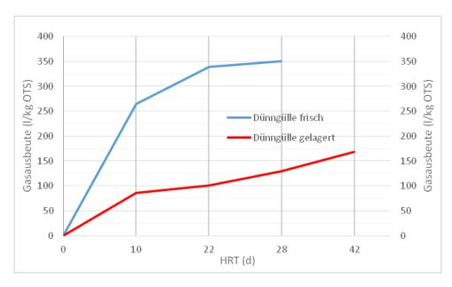
Abbildung 10: Gasausbeute frischer und gelagerter Dünngülle. Die gelagerte Dünngülle wurde nach etwa 10 Wochen Lagerdauer beprobt. Dargestellt sind nur die Werte bei 10, 22, 28 und 42 Tagen Verweildauer.
