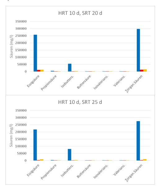
Abbildung 11: Säurerückhalt bzw. Säuremengen im UF-Retentat bzw. UF-Permeat während der Vergärung im MBRplus bei unterschiedlichen SRT von 20 Tagen (oben) bzw. 25 Tagen (unten). Blaue Säule = Fermenterinhalt; rote Säule = UF-Permeat; gelbe Säule = UF-Retentat (Überschussschlamm).
