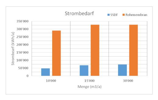
Abbildung 12: Strombedarf der SSDF (im MBRplus) und der UF mit organischen Rohrmembranen (im MBR-II). Der Strombedarf betrifft nur den Bedarf der UF ohne die Separierung und die Vergärung.
