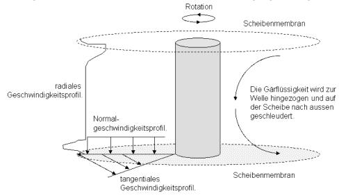
Abbildung 18: Filtrationssystem mit rotierenden Membranen. Das radiale Geschwindigkeitsprofil erlaubt eine schonende und energiesparende Betriebsweise der Filtration mit wirkungsvoller Abreinigung der Deckschicht auf der Membran. Im Vergleich zu Rohrmembranen lassen sich bis zu 84 % an Energie einsparen [Liebermann, 2012].
