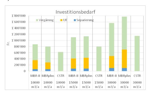
Abbildung 14: Investitionsbedarf für den MBR-II, den MBRplus und die konventionelle Vergärung im Rührkessel (CSTR)
