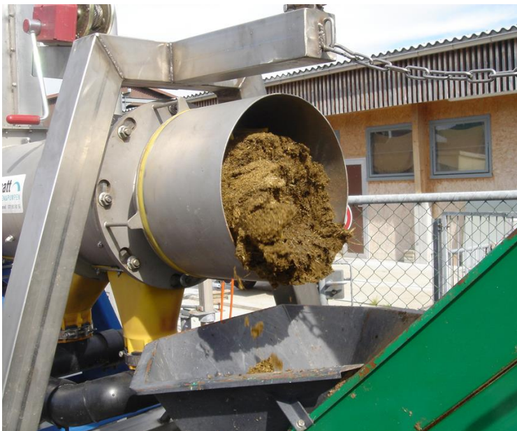
Abbildung 3: Siebpressschnecke als fahrbares Gerät im überbetrieblichen Einsatz.
