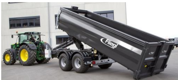
Abbildung 4: Traktorgezogenes Hackenliftgerät mit Abrollmulde. Die Mulde ist befahrbar.
