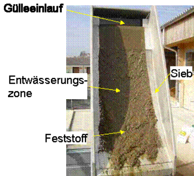
Abbildung 1: Das für die Separierung der Rohgülle eingesetzte statische Bogensieb
